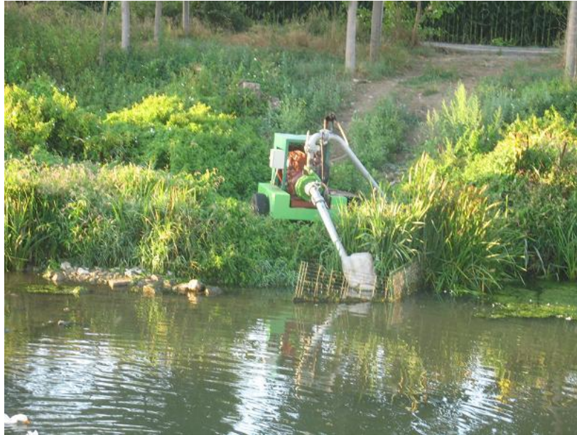
Figura 2-10. Detracción puntual de agua
