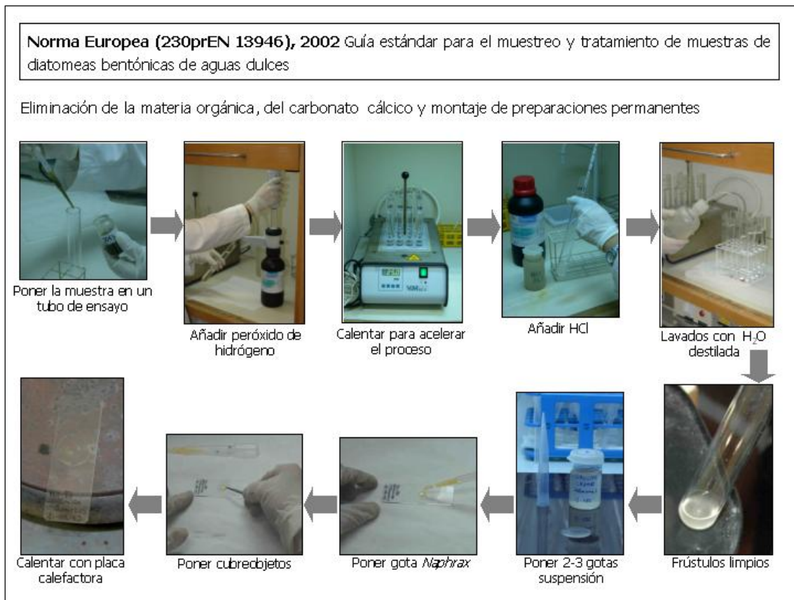
Fig. 1. Protocolo tratamiento digestión de diatomeas y montaje de preparaciones microscópicas.
