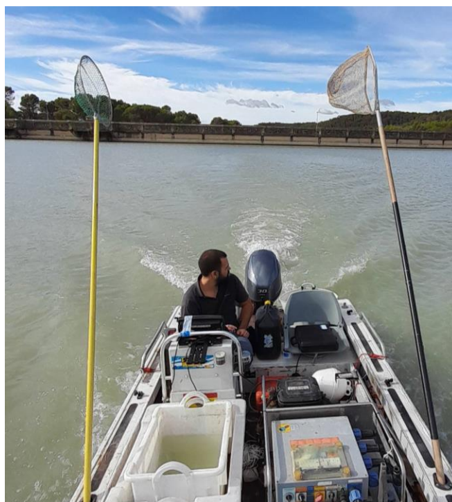
Figura 9. Equipo de electropesca desde embarcación en el embalse de Ardisa
